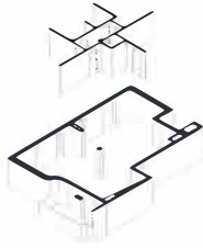
Demolizione dei tramezzi murari esistenti
